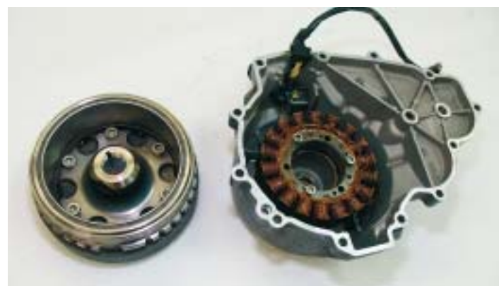
Il volano con il gruppo elettrico, entrambi montati nel co-perchio del semicaratter di sinistra.
