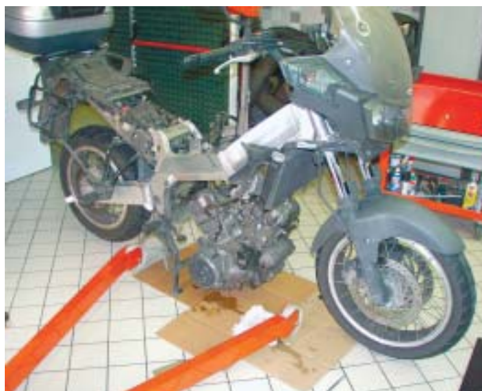
Con l'ausilio del sollevatore si smonta il propulsore.
