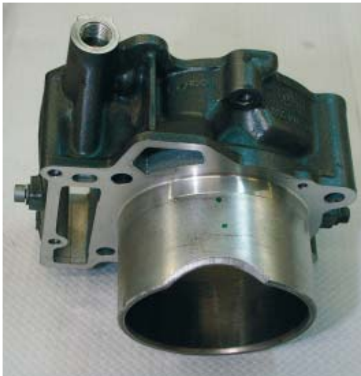
Il cilindro visto dalla parte inferiore. Si noti, in alto, il foro per il passaggio della catena della distribuzione.
