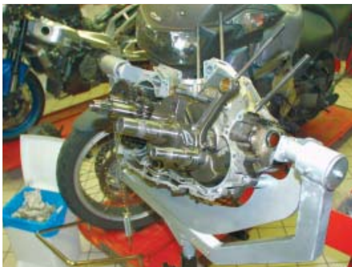
L'immagine evidenzia l'allineamento dei due alberi del cambio con quello motore e quello di equilibratura.
