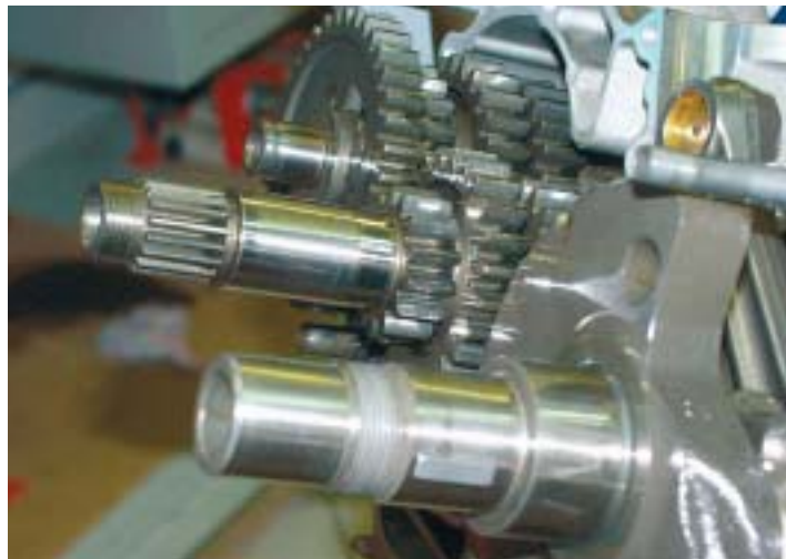
Una suggestiva immagine del gruppo cambio con in primo piano il perno di destra dell'albero motore che si prolunga nel terzo cuscinetto, quello iperstatico.
