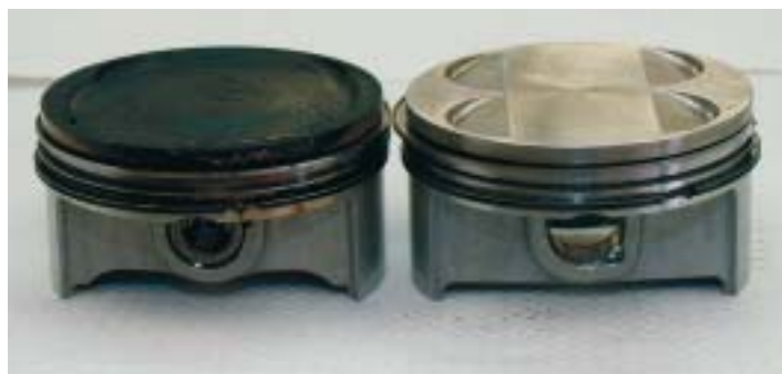
Pistoni a confronto. A sinistra quello della Caponord, a destra quello della più spinta RSV 1000. Si noti come il secondo sia molto più compresso.
