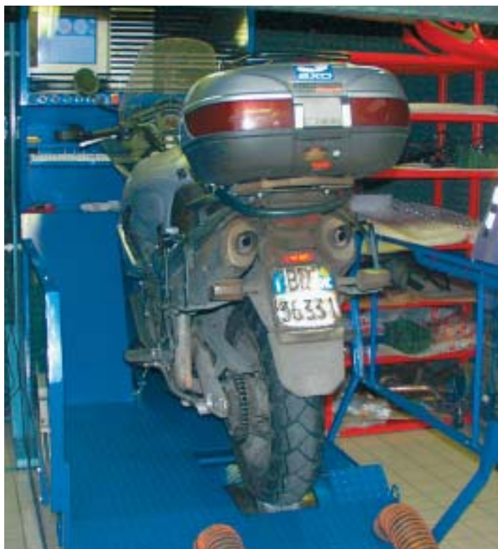
Prima di essere smontata, la motocicletta è stata provata al banco per documentarne le prestazioni dopo aver percorso un gran numero di chilometri.
