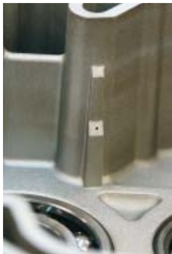
Il minuto foro, ricavato nel cater, consente la lubrificazione a caduta degli ingranaggi del cambio.
