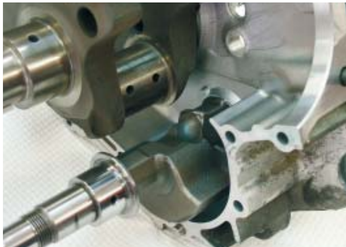
Un particolare dell'albero frontale di equilibratura. Si nota la svasatura necessaria per non urtare la biella durante la rotazione.
