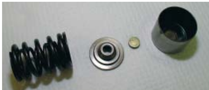
Il richiamo delle valvole è affidato a due molle elicoidali e coassiali.
