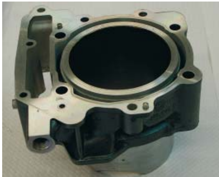
Il cilindro visto dall'alto. Si noti la struttura Open Deck.
