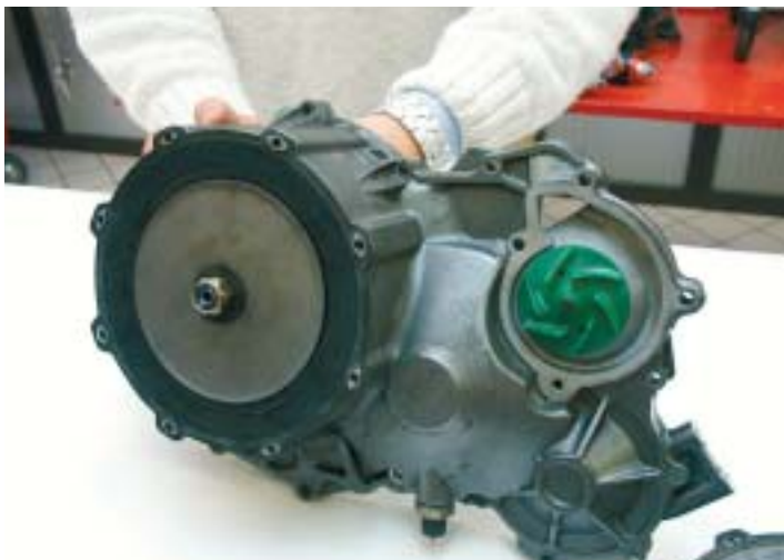
Il lato esterno del coperchio di destra. Sulla sinistra la membrana a protezione della frizione.
