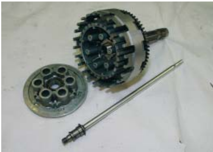
Il corpo della frizione con l'astina di comando. Mancano i dischi di attrito.
