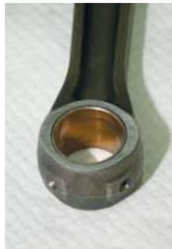
Il piè di biella prevede due fori per la lubrificazione. Si notino i rinforzi in corrispondenza di questi.
