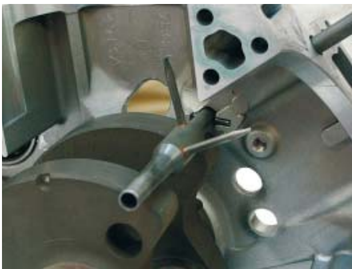
I due ugelli in primo piano consentono il raffreddamento dei pistoni attraverso un getto di olio nella zona inferiore.
