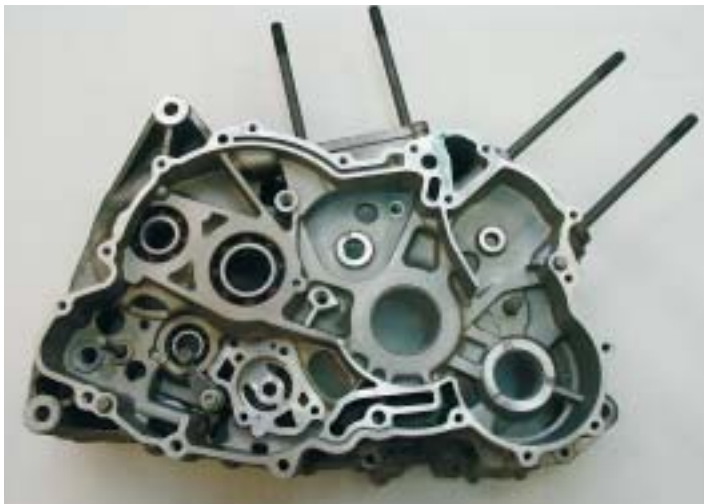
La parte esterna del semicarter di destra. È possibile vedere, sulla sinistra, la zona dove andrà posizionata la frizione. In basso al centro, l'alloggiamento di una delle pompe dell'olio.
