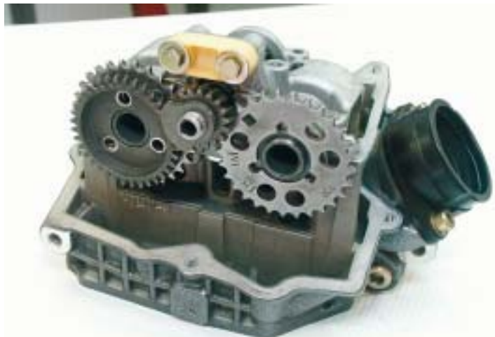
Il castello montato sulla testata insieme agli alberi a camme. Si noti l'ingranaggio che consente di raddoppiare la velocità angolare dell'albero di equilibratura rispetto a quello a camme di scarico.
