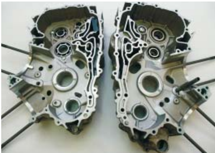
Ecco la parte interna dei due semicarter. Al centro i cuscinetti per l'albero motore. In basso quelli per l'albero di equilibratura ed in alto i due cuscinetti volventi per il cambio.
