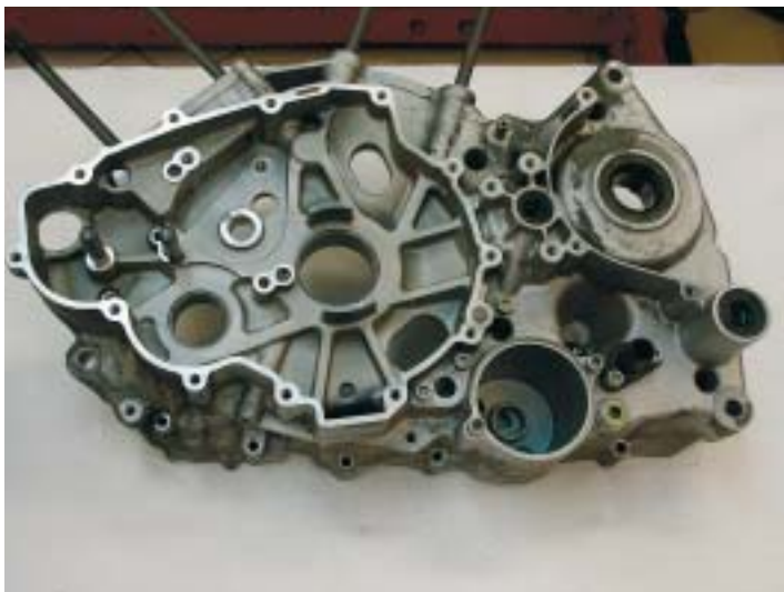
La parte esterna del semicarter di sinistra. Qui viene alloggiato il volano. Sulla destra si può notare la zona riservata alla trasmissione finale a catena.
