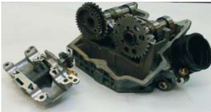
Il complesso della distribuzione disassemblato.
