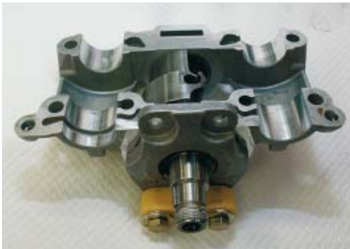
Questo è il castello che chiude gli alberi a camme del cilindro posteriore (rispetto al senso di marcia). Si noti al centro il secondo albero di equilibratura.
