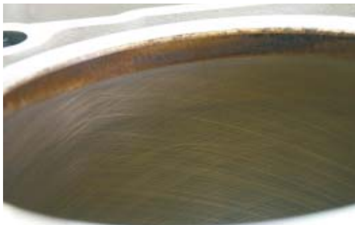
La superficie rettificata dei cilindri sembra non aver subito l'abrasione da parte di fasce e pistone.
