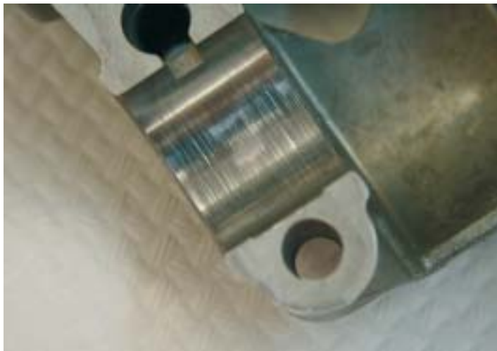
Uno degli alberi a camme. I perni, dopo più di 80000 km, appaiono molto usurati.
