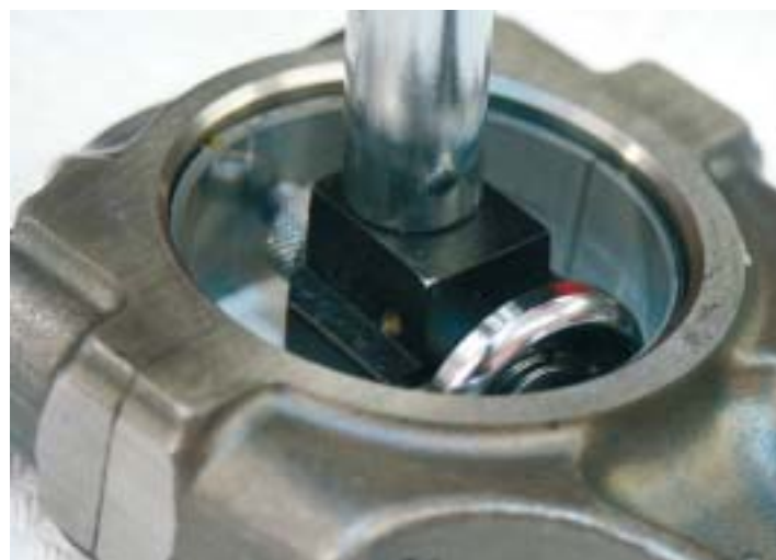
L'alesametro nelle mano di Fiorenzo permette il rilevamento del diametro della bronzina di biella. Questo componente è stato l'unico a oltrepassare il limite di usura imposto dalla Casa madre.
