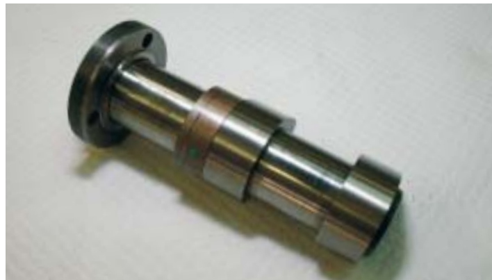
Uno degli alberi a camme. I perni, dopo più di 80000 km, appaiono molto usurati.
