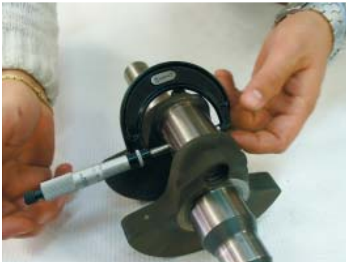
Il diametro del perno di biella è stato misurato numerose volte su più punti. Questa è una zona in cui l'usura è maggiore.
