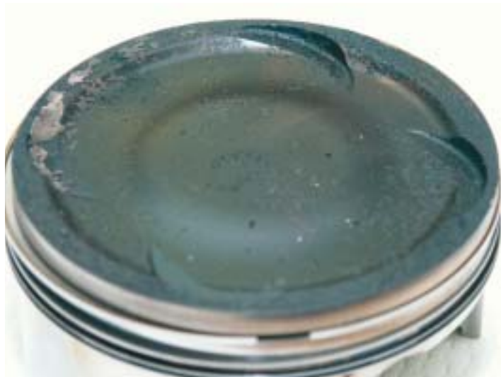
La superficie superiore del pistone posteriore è completamente ricoperta di incrostazioni. Che tale strato abbia permesso un incremento del rapporto di compressione tale da mantenere inalterate nel tempo le prestazioni?
