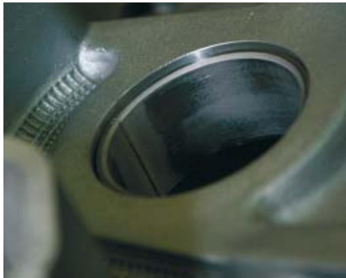
Come è possibile osservare nell'immagine, una delle bronzine di banco presenta zone di usura visibili ad occhio nudo.
